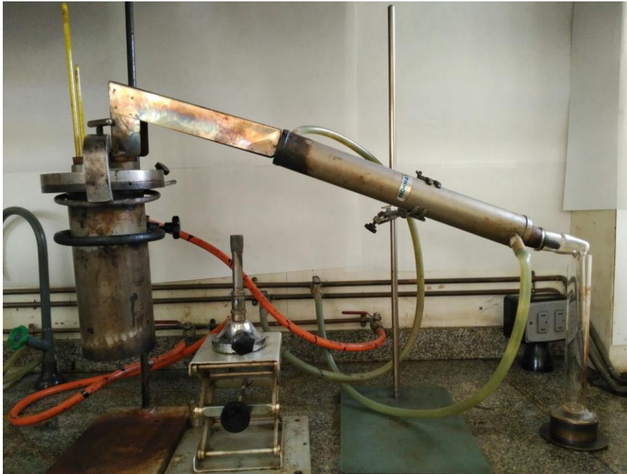
Foto 1. Detalle montaje del equipo de destilación en laboratorio.
